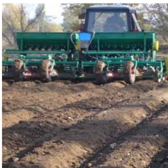
Рис. 2. Сеялка-гребнеобразователь СГС-4,2 в работе
